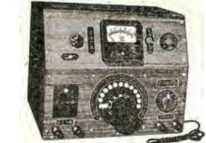
5A 電源装置
