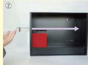
② 側面の穴から注射筒で煙を送ります。煙は熱源がOFFのときはまっすぐ横に動きます。
