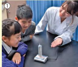
① 補充液をセットして電源を入れると数秒で煙がでます。煙を注射筒にあつめます。
