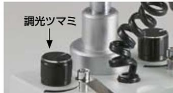
調光装置の採用により、最適な光量で観察できます (NL-LEDのみ)。
