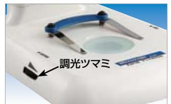
調光装置の採用により、最適な光量で観察できます。
